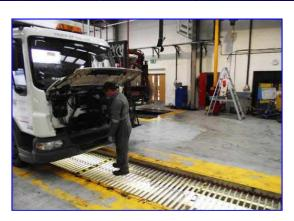
Защитные шторки на яму необходимы для закрытия смотровых канав и других проемов в полу. Несущие элементы изготовлены из алюминиевого сплава АДЗ1Т1. Одна секция ЗШ имеет длину в развернутом состоянии 1,7 метра. Возможно изготовление секций разной длины.
