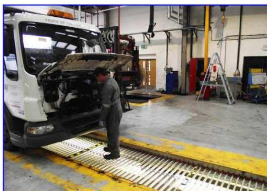
Защитные шторы на яму необходимы для закрытия смотровых канав и других проемов в полу. Несущие элементы изготовлены из алюминиевого сплава АД31Т1. Одна секция 3Ш имеет длину в развернутом состоянии 1,7 метра.
